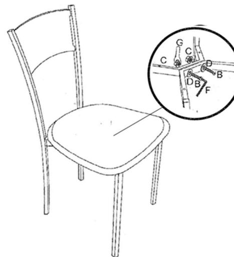
EN EL TERCERO PASO, APRIETE LOS TORNILLOS CON LA ESTRUCTURA APOYADA EN EL SUELO, EN EL LUGAR DÓNDE VA A SER UTILIZADA
